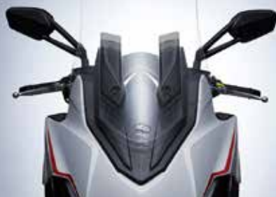
Výškově nastavitelný větrný štítek
